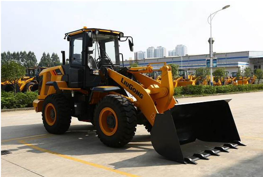
Рисунок 1.3.7. Фронтальный погрузчик г/п 3 тн, объем ковша 1,8 м³
