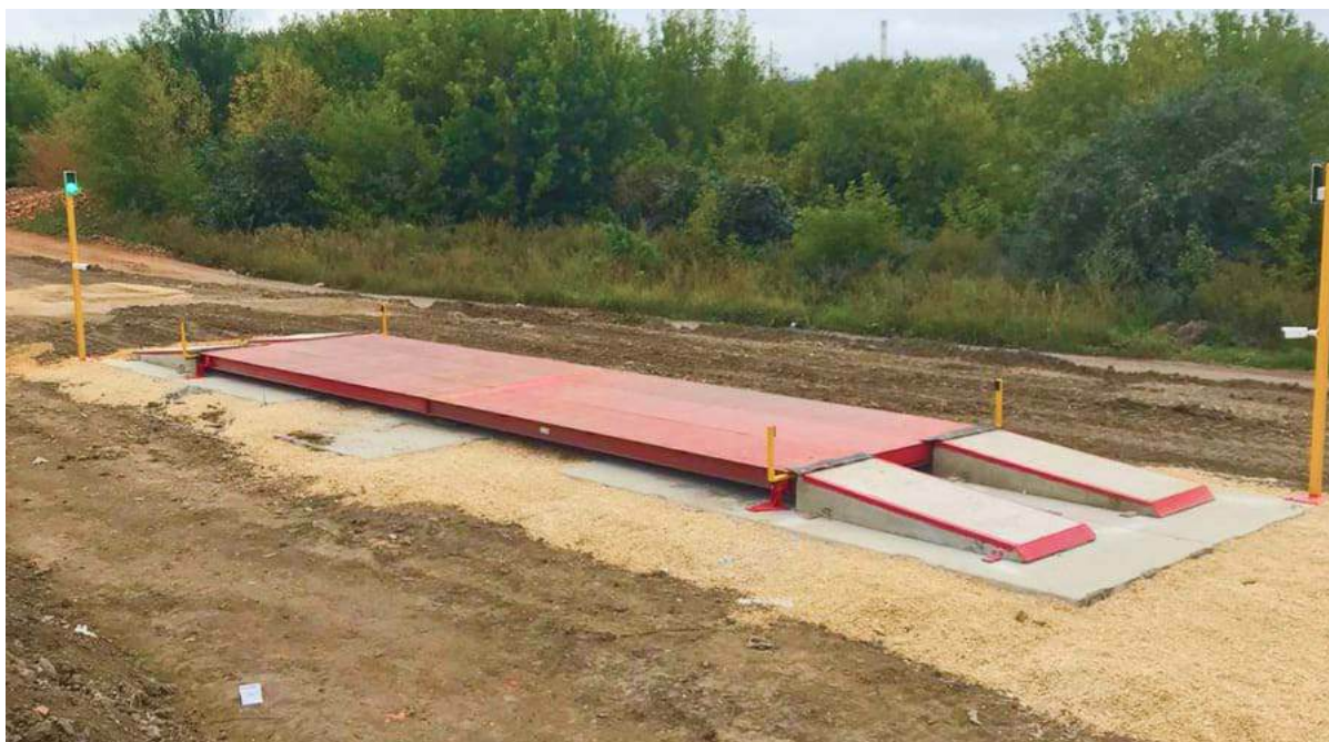
Рисунок 1.3.3. Весы автомобильные платформенные
